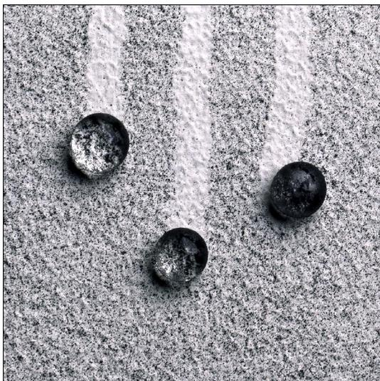
Bild 3: Regenwasser perlt an der Fassade herunter und spült Schmutzpartikel, Algen- und Pilzsporen ab.
